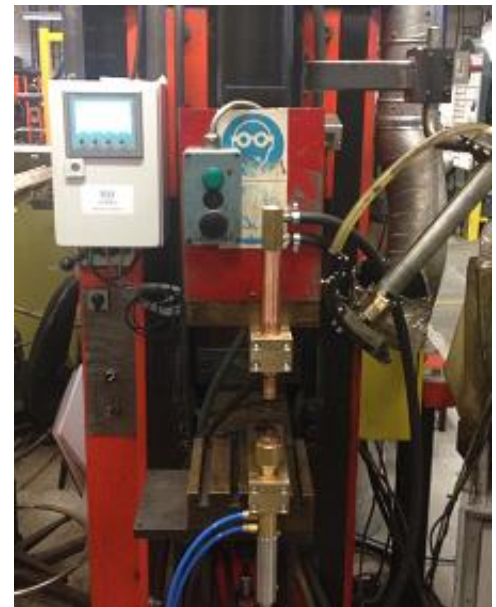
BM Nut Checker™, monterad på en äldre svetsmaskin.
