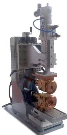
TSA MOLETTE. Sömsvets huvud. Presskraft 50- 100 daN.
