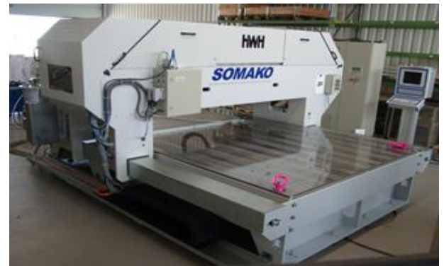
Svetsning av bultar. Arbetsområde 3,2 x 2,0 m. Med automatisk bultmatning.
