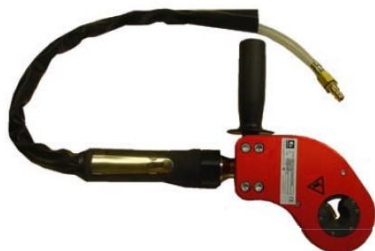
BF 2400 Tryckluftdriven handhållen formerare. Med denna formerare kan elektroderna återställas utan att de behöver lossas från maskinen. OBS! Både över- och underelektroden ska formeras samtidigt.
