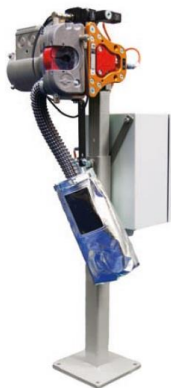
BFS 3600. Eldriven formerare för robottänger med ett skärhuvud.
