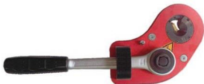
BF 2470 Handhållen formerare. Elektroden kan återställas utan att de behöver lossas från maskinen. OBS! Både över- och underelektroden ska formeras samtidigt.
