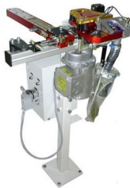
BKS 5810 Kombinerad formerare och elektrodväxlare med magasin för elektrodhåttor samt övervakningssensor.
